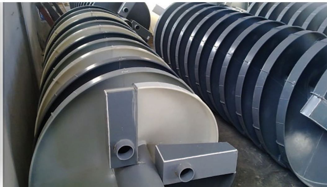
Chế tạo vít xoắn tuyến quặng PVC - Screw ore
